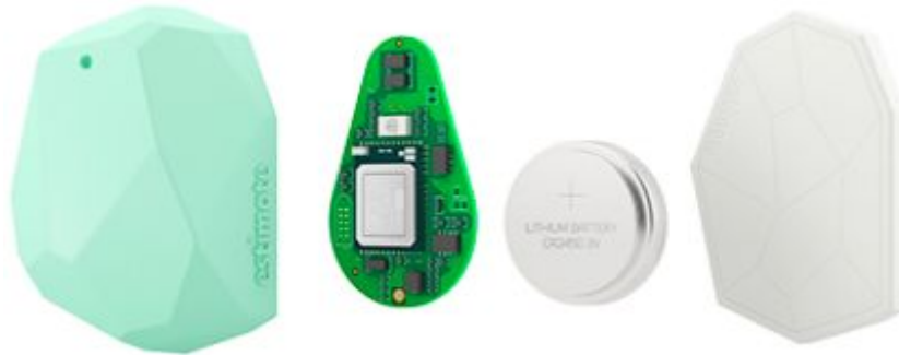
Figura 1 - Ilustração de um Beacon desmontado
