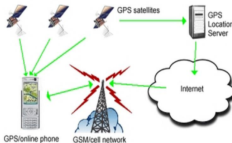
Figura 3 - Esquema de Geolocalização
