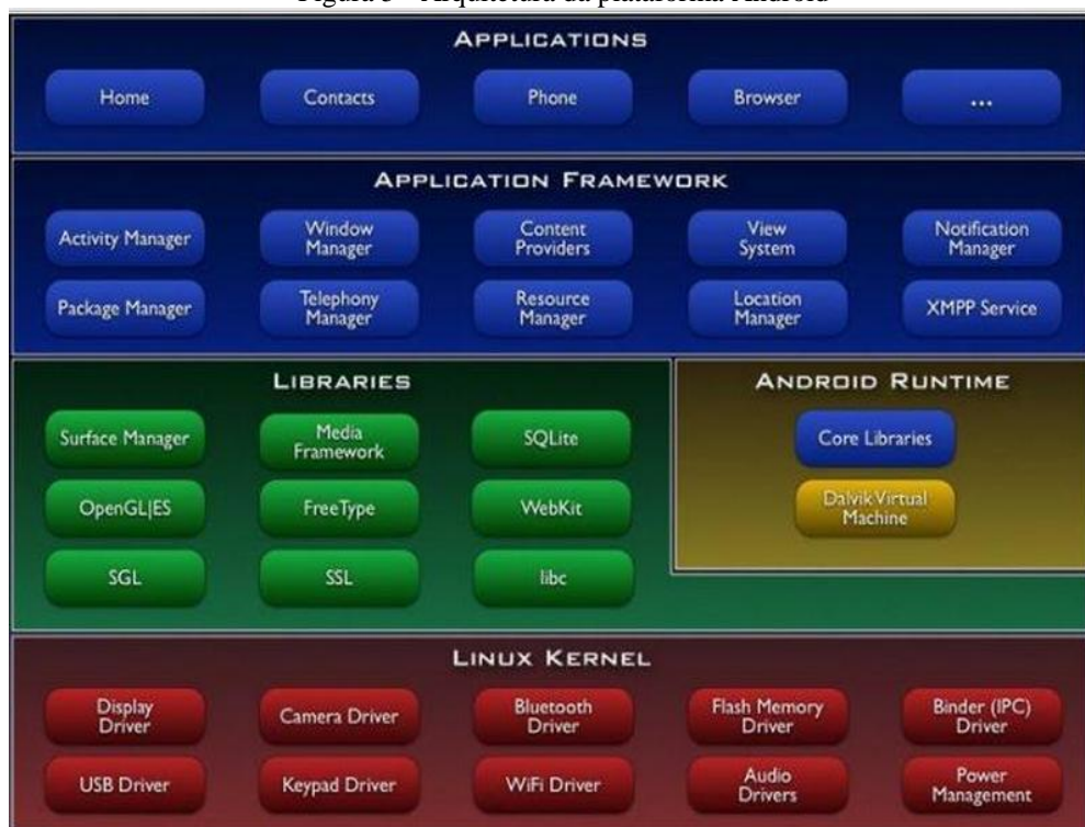
Figura 5 - Arquitetura da plataforma Android
