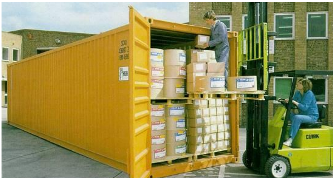
Figura 3: Container de 9'6" de altura e 40 pés de comprimento
