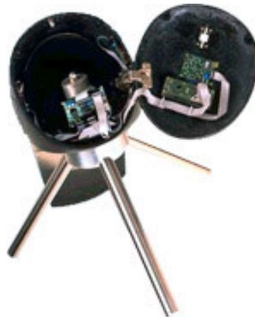
**Figura 5: Placa controladora dentro da catraca.**
