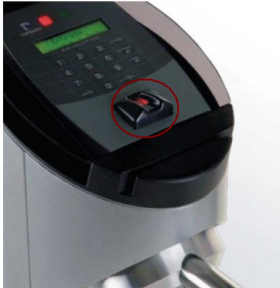
**Figura 4: Dispositivo de leitura biométrico (impressão digital).**
