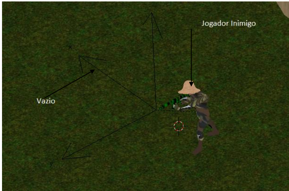
Figura 49 - Objeto Empty.001(Vazio) filho ligado ao esqueleto (Armatrure) do jogador inimigo, embaixo da textura de camuflagem.
