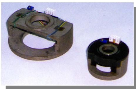
**Figura 6: Célula de Carga com 4 Strain Gauges Montados**
